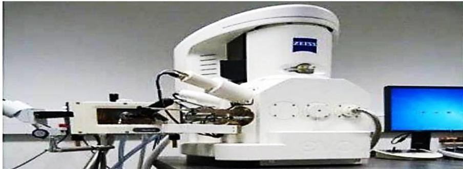
الشكل (7-2) : مطيافية تشتت الطاقة بالأشعة السينية (EDX) الموجود في جامعة طهران
